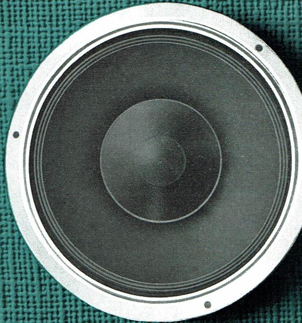
incompatible avec l'obtention d'un taux minime de distorsion ; d'autre part, la fréquence-limite de fonctionnement en piston, est d'autant moins élevée que le diamètre du diaphragme est plus grand.
