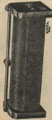
**Bobine de Self**, modèle à un curseur, se plaçant dans le circuit de l'antenne pour en modifier la longueur et obtenir ainsi la résonance, joues carrées acajou verni, pièces cuivre polies et vernies.
